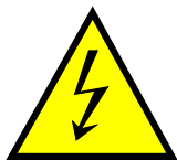
Figure 2 Marquage de l'équipement sous haute tension
